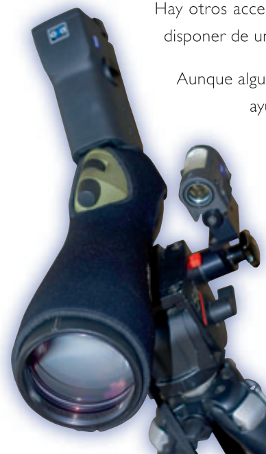
Detalle del montaje del Z-Point en el cabezal del trípode con el Zeiss 85 FL y el DC4
